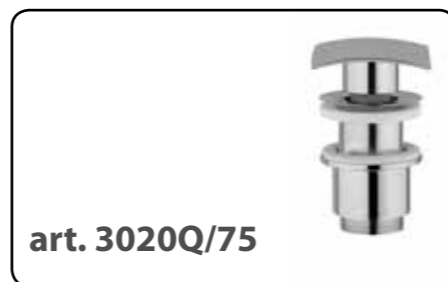
Piletta 1"1/4 - H.75 senza troppo pieno, tappo quadrato 70mm in ottone, sistema comando sempre aperto Pop-up waste 1"1/4 - H.75, without overflow, brass square plug 70mm, "always open" control system
