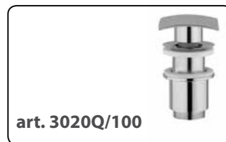
Piletta 1"1/4 - H.100 senza troppo pieno, tappo quadrato 70mm in ottone, sistema comando sempre aperto Pop-up waste 1"1/4 - H.100, without overflow, brass square plug 70mm, "always open" control system
