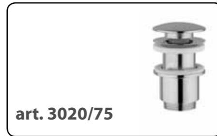
Piletta 1"1/4 - H.75 senza troppo pieno, tappo in ottone Ø72mm, sistema comando sempre aperto Pop-up waste 1"1/4 - H.75, without overflow, brass plug Ø72mm, "always open" control system
