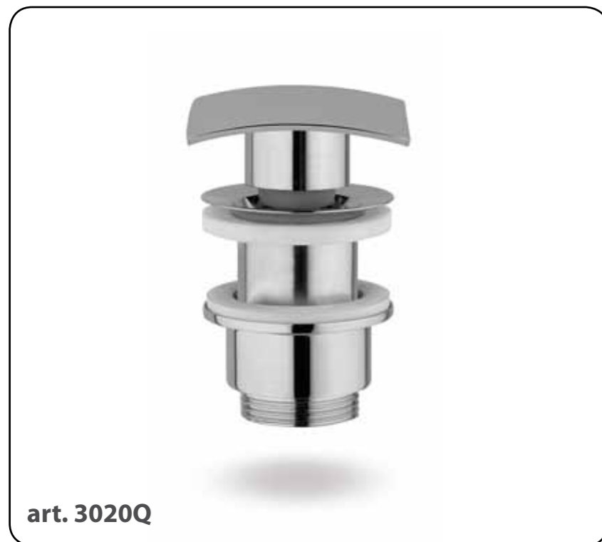
Piletta 1"1/4, senza troppo pieno, tappo quadrato in ottone 70mm, sistema comando sempre aperto Pop-up waste 1"1/4, without overflow for washbasin, brass square plug 70mm, "always open" control system
